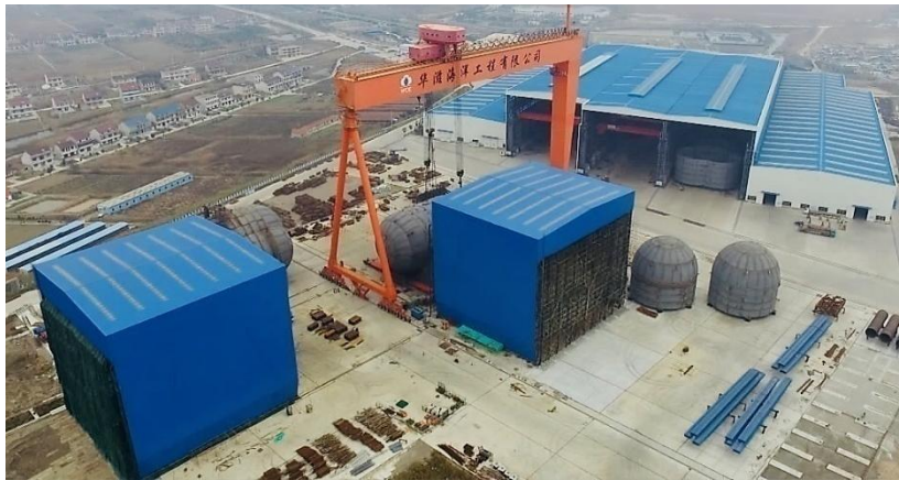
Block turnover by 1000T crane 利用1000T龙门吊进行液罐总段翻身
