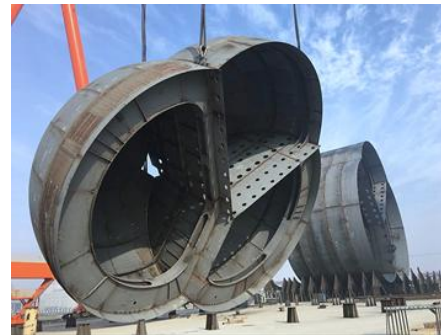
Block turnover by 1000T crane 利用1000T龙门吊进行液罐总段翻身
